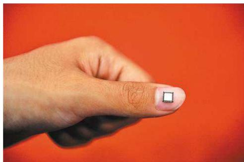
サイズが 6mm 四方で、長距離伝送能力があり物質透過性も強い、世界初の 433/470MHz 工業物聯網用チップセット、CY4520 が重慶郵電大学より発表され、既に少量を生産中と発表した。
