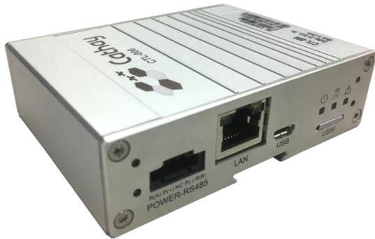
CTL-006はSIMCom製SIM7600JC-Hモジュールを内蔵し、マルチキャリア・マルチバンドLTE対応でRS485/USBインターフェースを持つ、高品質、ハイパフォーマンスのM2M/IoT通信小型ルーターです。FDD-LTEネットワークを介してLTEデータ転送機能を持ち合わせており、PoE受電対応(※)LANポートで有線ネットワークを使用することも可能です。ダウンリンク時最大150Mbps、アップリンク時最大50Mbpsのカテゴリ4転送速度を実現しています。RS485専用インターフェースと併せて、MicroUSBインターフェースでOTG機能もサポートしていますので、シリアル有線設備機器やUSB接続機器のLTE通信モデムとしてご利用可能です。マルチキャリア対応により挿入されたnanoSIMカードを自動判別し、NTTドコモ/KDDI(au)/ソフトバンク回線のいずれも通信可能です。(※PoEは追加Option機能として提供されます。
